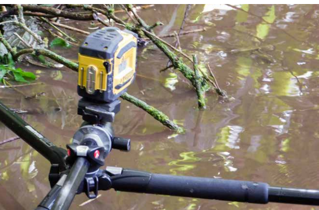
obrázek 12 – měření za pomoci laserové vodováhy
