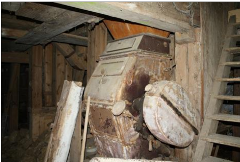
Obrázek 2 - šrotovací stolice (Podvicmanovský mlýn, Vicmanov)
