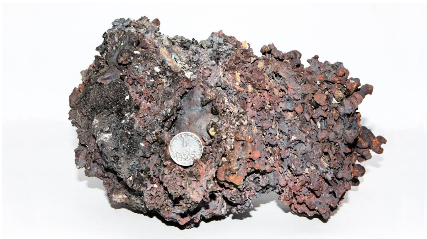
Obr. 19 Kus tzv. železné houby (mix strusky, železa, popela, uhlíku) vytažený z pece po vychladnutí. Z tohoto materiálu bylo nutné kousky čistého železa vyseparovat (drcením, lámáním). Korunová mince jako měřítko. (Foto: Tomáš Kudláček).
