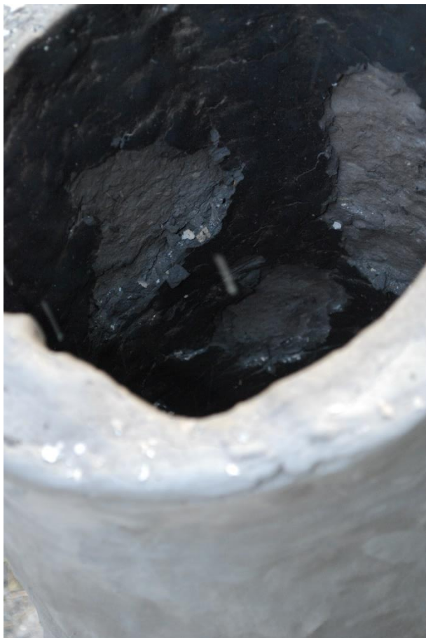
Obr. 14 Popraskaný vnitřek během pece a světlá místa po odlomených kusech jílu. (Foto: Marek Matura)
