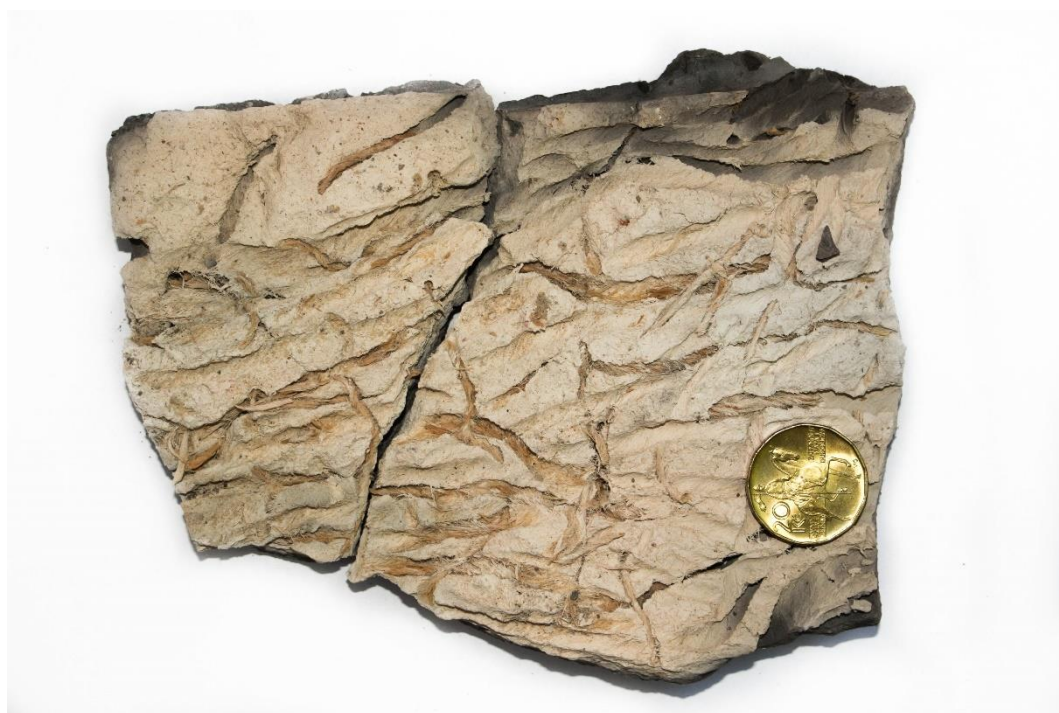
Obr. 4 Dutiny v kusu stěny pece zbylé po vypálení jutové tkaniny. (Foto: Tomáš Kudláček)
