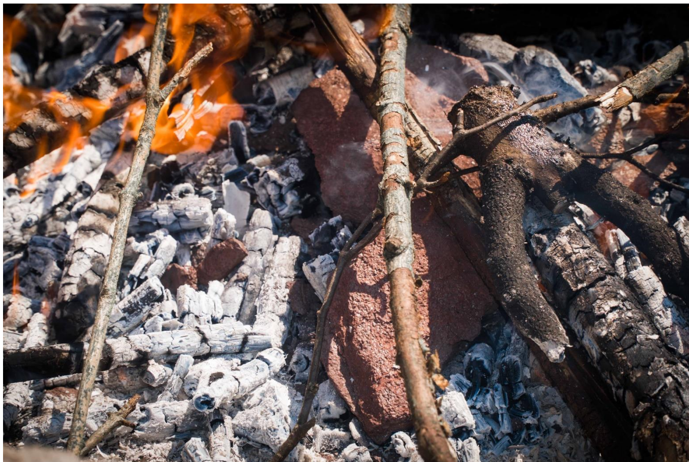
Obr. 11 Pražení železné rudy v ohni před samotnou tavbou. (Foto: Matouš Bičák)
