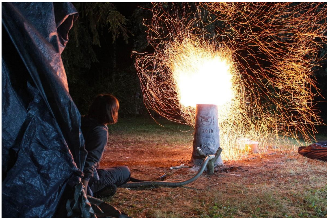
Obr. 16 Jiskry vylétávající z komína pece při zážehu kychtových plynů. (Foto: Tomáš Kudláček)
