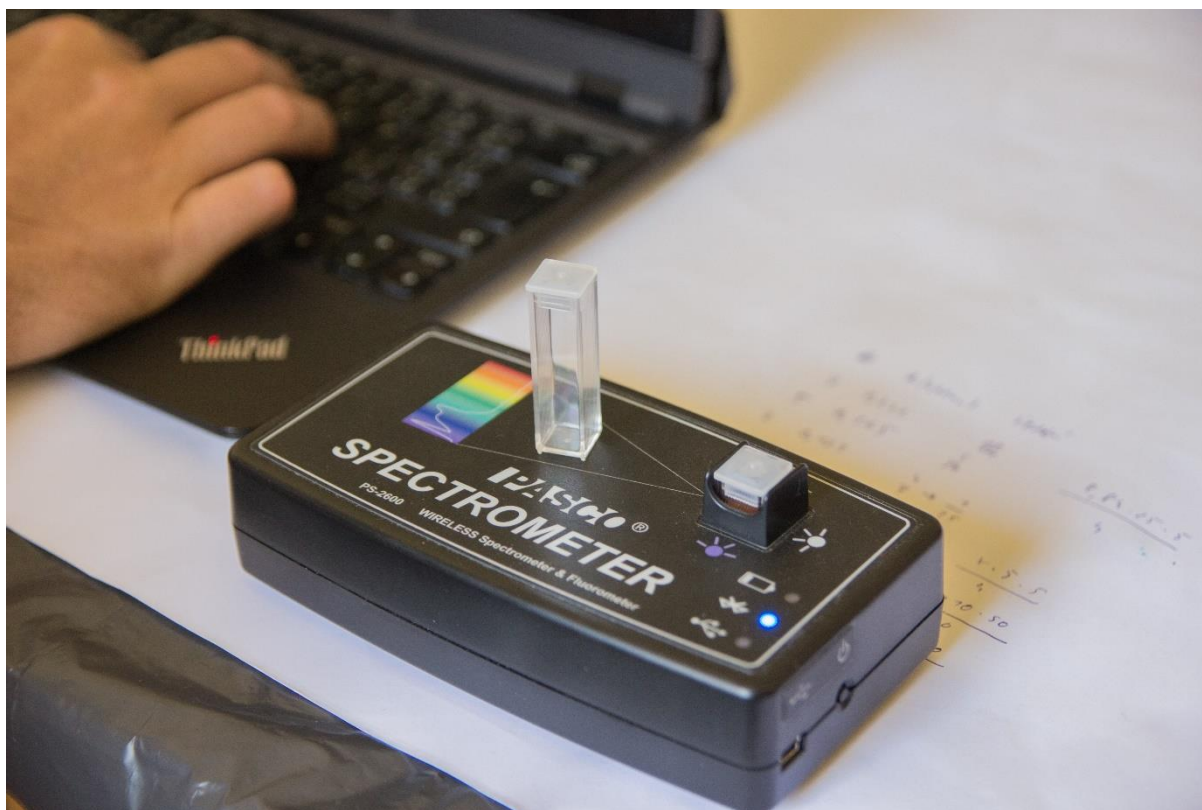
Obr.12 Bezdrátový spektrofotometr PASCO Wireless Spectrometer PS-2600 a kyveta na analyzované vzorky. Foto: Tomáš Kudláček
