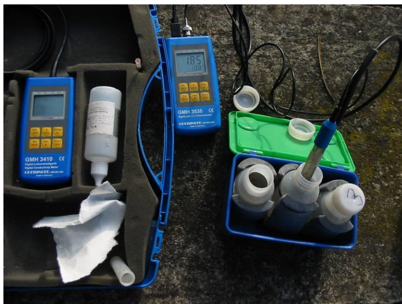
Obr. 4 měření odebraných vzorků (odběrový bod I) přístroji značky Greisinger
