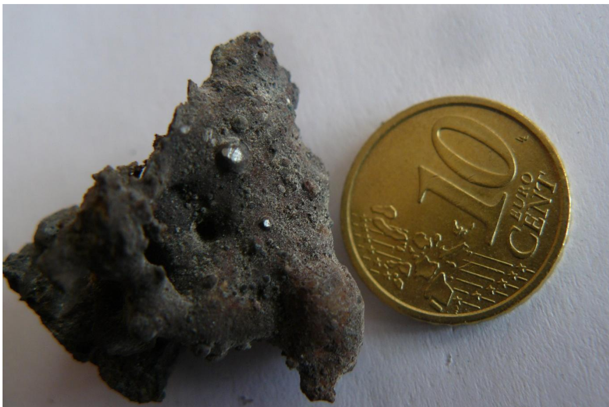
(Obr. 5) Viditelné železné kuličky
