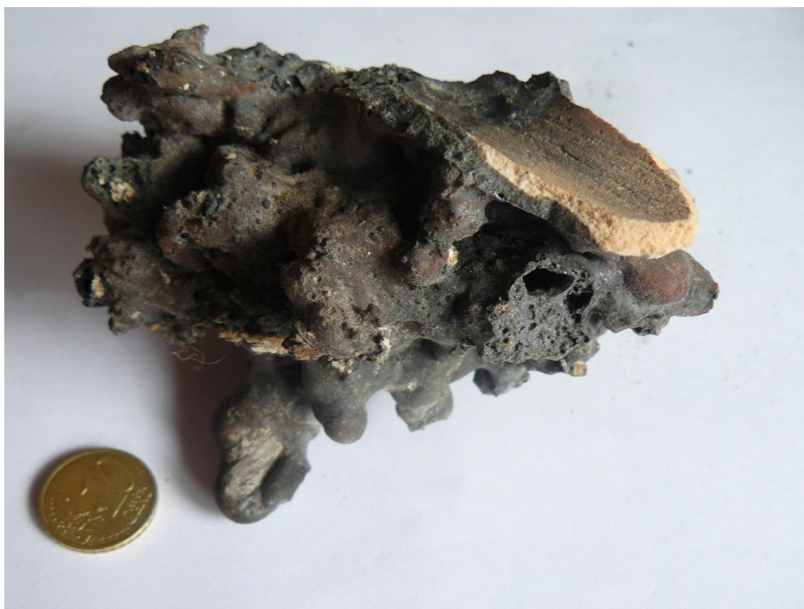
(Obr. 2) Tvrdá struska obsahující kousky železa (pod dyšnou)
