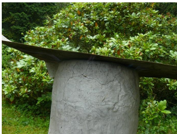
(Obr. 5) Zakrytí pece po dokončení vsazování rudy a uhlí
