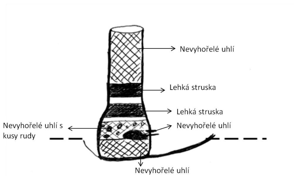
(Obr. 9) Materiál v peci po ukončení tavy
