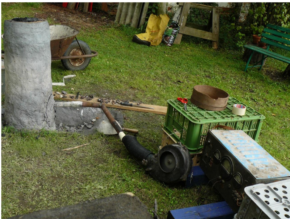
(Obr. 1) Umělý přívod vzduchu do pece (nabíječka autobaterií a chladič z auta)
