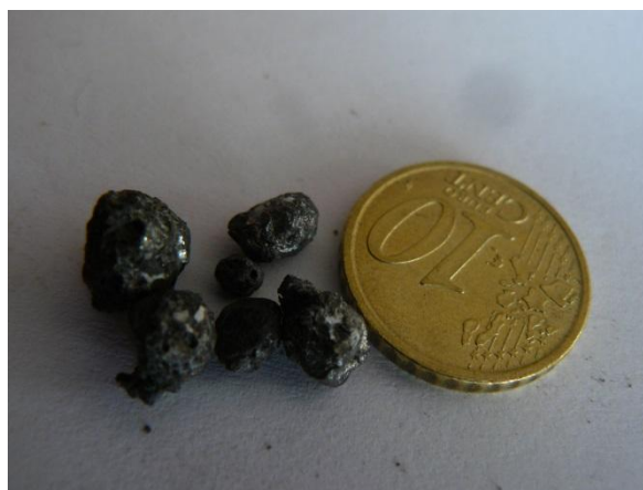
(Obr. 7) Vyseparované železné kuličky
