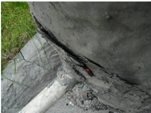
(Obr. 2) Praskání dvířek po vysušení
