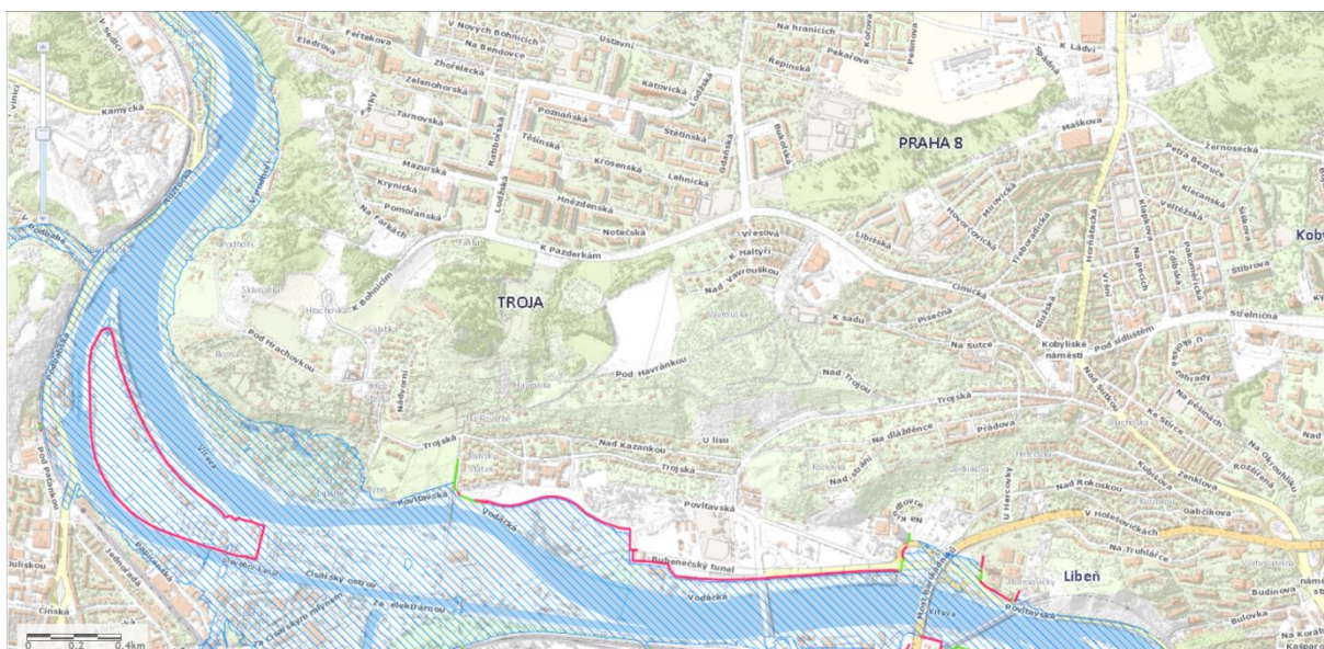
obr.14. Průtok 100leté vody s protipovodňovými opatřeními
