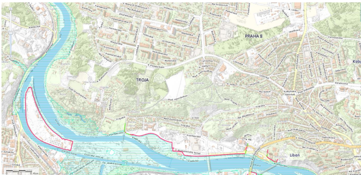
obr.12. Průtok 20leté vody s protipovodňovými opatřeními
